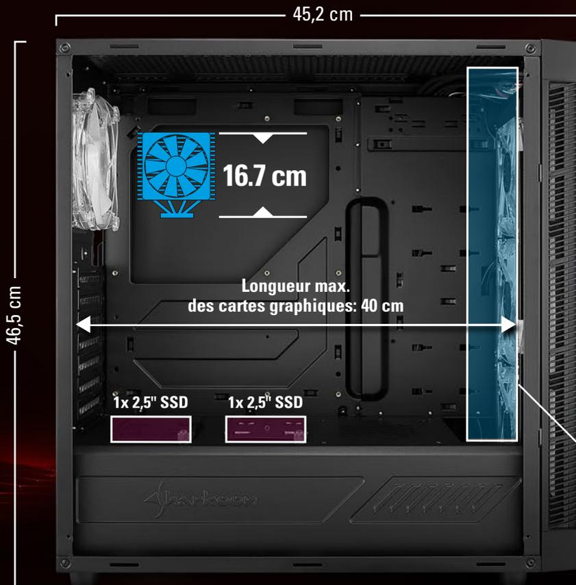
Un matériel performant demandant de l'espace, le TG5 Pro RGB a été conçu spacieux. Il supporte les cartes graphiques d'une longueur maximale de 40 cm, les refroidisseurs CPU d'une hauteur allant jusque 16,7 cm et les alimentations d'une longueur maximale de 20,5 cm. De plus, jusque trois disques durs de 3,5" et jusque quatre SSD de 2,5" peuvent être installés à l'intérieur du boîtier.
